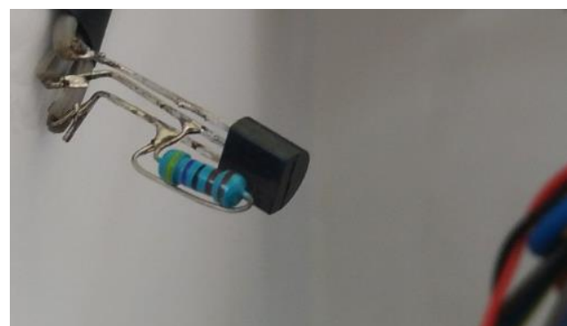
Gambar 4. Rancangan Sensor DS 18B20
