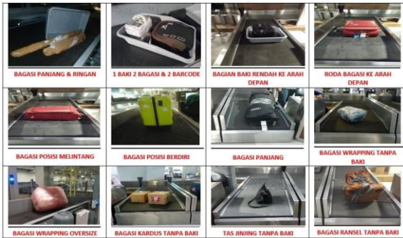
Gambar 8 Peletakan bagasi yang salah
