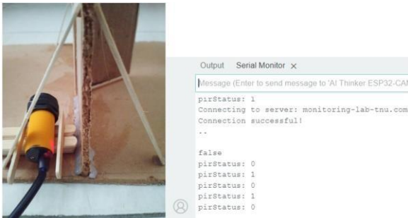
Gambar 8. Sensor Proximity Infrared 0 Pada gambar 8. penulis melakukan pengujian pada sensor proximity infrared , apabila sensor tidak mendeteksi adanya objek yang melintas, maka lampu LED akan menyala dan status di Arduino 0.
